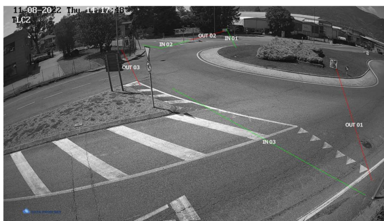
Figura 25 Schema della configurazione delle spire sul video di traffico Telecamera 02
