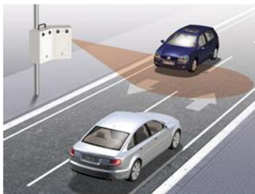
Figura 2 Schema di installazione dei Radar Viacount
